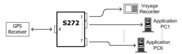
當我們把 GPS 接收器的 RS232 串口與 S272 的主串口連接上之後,每一個從串口就可以與應用設備連接,於是由 GPS 接收器發出的 GPS 資料就可以同時傳給每一台設備進行應用處理,於是一台 GPS 接收器就可以同時服務七台設備。. 如果我們要服務更多台設備則可以再多加 S272 來進行級聯動作,把前一級 S272 的一個從口與下一級 S272 的主口連接則我們可以增加六個 RS232 接口(雖然 S272 可以有七個從口,但是我們必須用一個上一級 S272 的從口所以只淨增加六個從口)。理論上我們可以用金字塔式的級聯方式每加一個 S272 就增加六個從口來滿足期望的 RS232 連線數。
