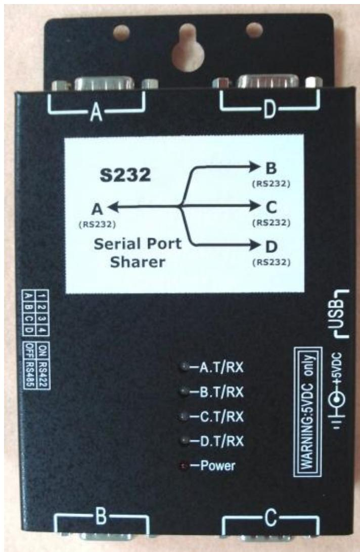
★ 串口 **A** 的任何資料可同時傳送給串口 **B,C,D**。
