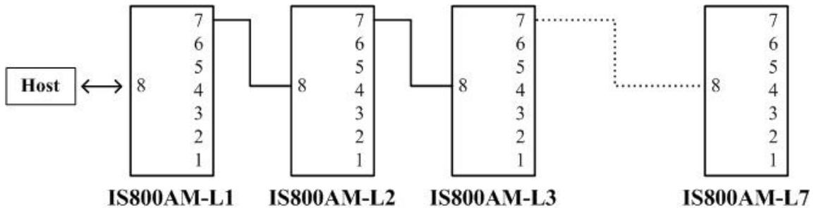
5. IS800AM 盒的串口 8 是主串口與主機連接。串口 1—7 是從串口與設備連接。如果我們只有一台 IS800AM 盒則只能支持 7 台設備。如果我要支持超過 7 台設備就要有多一台 IS800AM 盒來級聯。我們把第一級的 IS800AM 盒的串口 7 與下一級的 IS800AM 盒連接，於是我們就可以有最多 7 級的 IS800AM 盒存在。雖然每一級可以有 7 個從串口可連接設備，但是前面六級的 IS800AM 盒的串口 7 已被拿來與下一級 IS800AM 盒級聯用，所以只有最後一級 IS800AM 盒的串口 7 可以與設備連接。於是我們在最多七級 IS800AM 盒的應用環境中可以支持  $6*6+7=43$  個設備。
