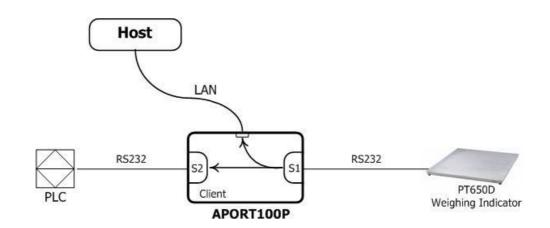
現在我們又碰到有些客戶會質疑電子秤是否會出現異常而不知,一方面可能是設備本身老化偏差,或設備系統損壞而出錯,或人爲調整設備造假,是否可以讓PLC連接多台電子秤以對比排除上述疑慮。針對他們向瑞旺公司提出的需求,我們採用 IS800A 可定址智慧型串口共享器方案來滿足。由於PLC 只有一個 RS232 串口,所以我們連接到 IS800A 的主口(master port),於是我們可以把連接到 IS800A 的從口(slave port)之電子秤的資料都傳給 PLC。由於電子秤是週期性傳送資料,所以我們首先要確保每一個電子秤的資料不會衝突的傳給PLC。此外每個電子秤的資料並無法分辨其來源,所以我們必須在每一個電子秤的資料封包前面加上ID 辨識碼,以令 PLC 在收到資料時可以知道是由何台電子秤傳來。
