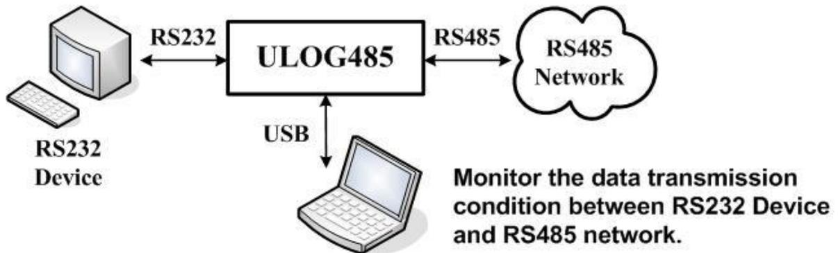
2. 在一些 RS232 設備必須利用 RS232 對 RS485 界面轉換器才可以連上 RS485 網絡的應用環境，我們可以同時紀錄 RS232 端及 RS485 端的資料傳輸狀態。
