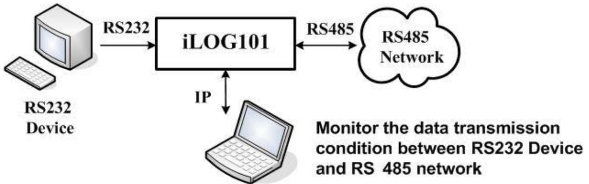
2. 所以在一些 RS232 設備必須利用 RS232 對 RS485 轉換器才可以連上 RS485 網絡的應用環境，我們利用 iLOG101 盒就可以同時完成轉換器的功能，又可以同時紀錄 RS232 端口及 RS485 端口的資料傳輸狀態。而且利用 IP 網絡，我們的監控地點可以在任何 IP 網絡可到達的地方。特別是被監控的 RS485 網絡環境如果是人類不適合長期存在的地方，iLOG101 盒更是最佳選擇。我們可以把資料如同影像或聲音一樣，即時監控及紀錄。
